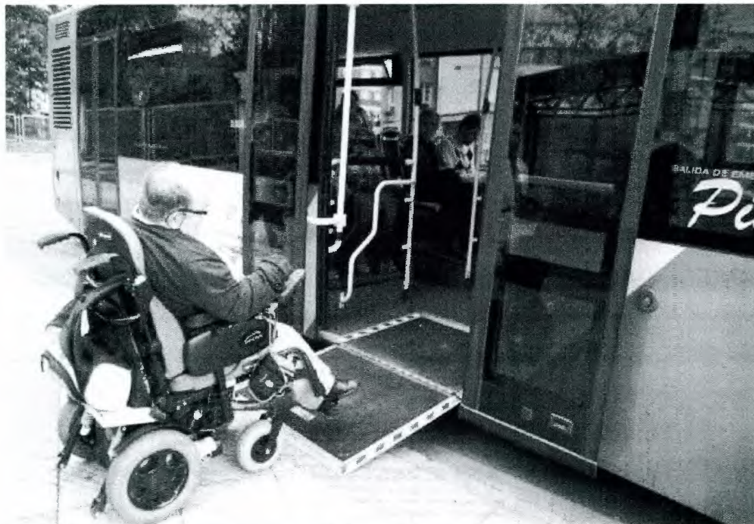
Figura 2. Modelo de rampa de acceso que se abre tipo libro (por encima de la puerta).
