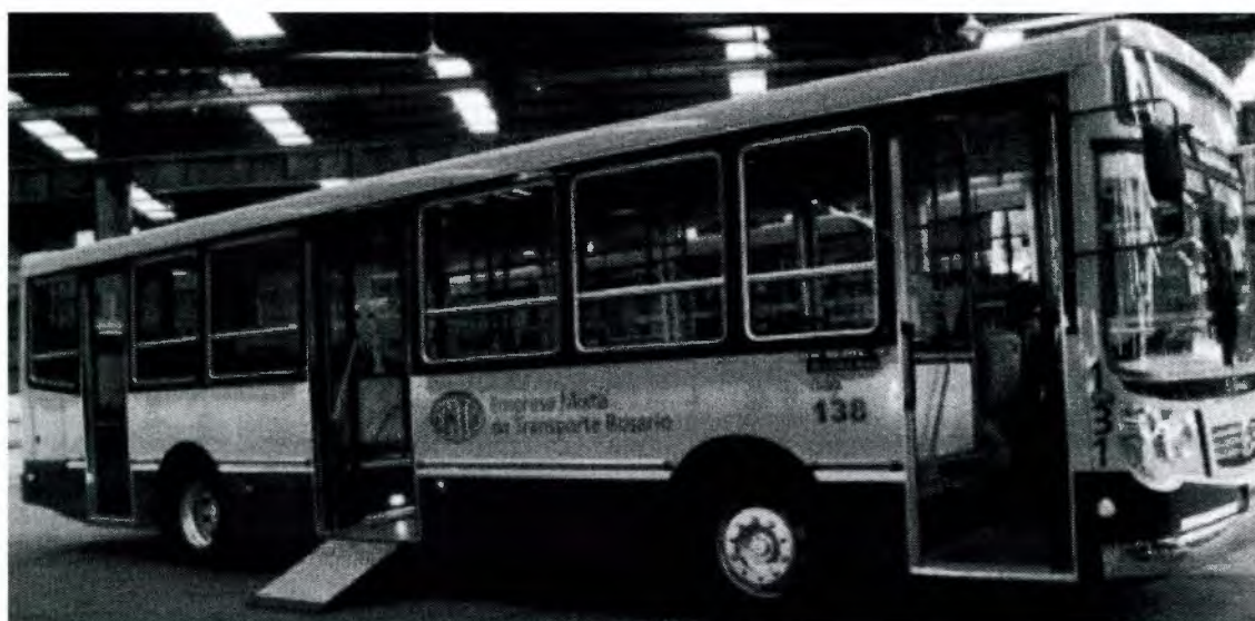
Figura 1. Modelo de rampa de acceso que se abre tipo caja de fósforos (y bajo la puerta).
